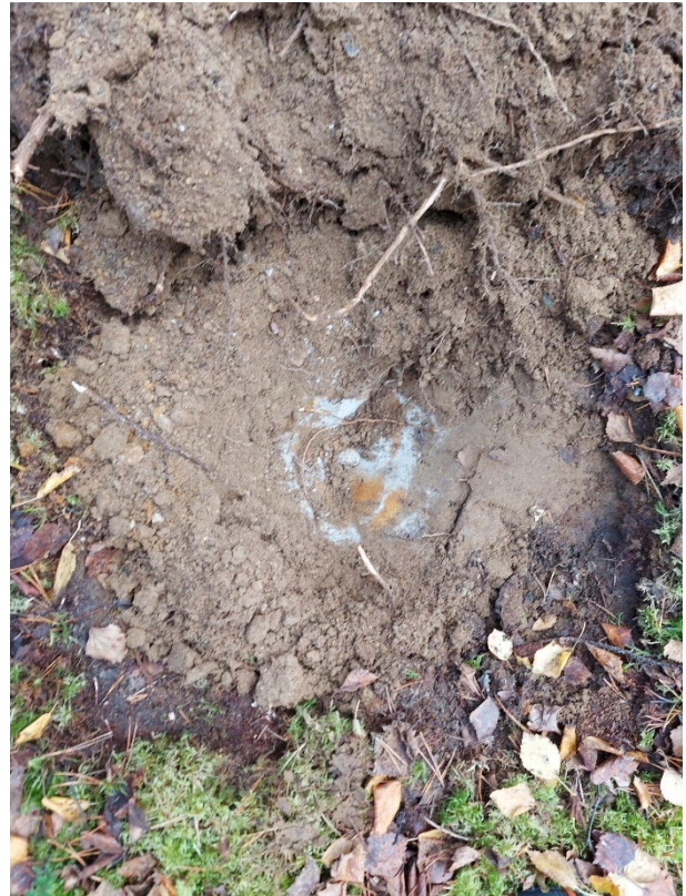
Kuva 50. Koepisto poropelloilta. Kuvassa näkyy ajettun likaisen hiekkakerroksen alta paljastuvat luonnolliset huuhtouma- ja rikastumakerrokset. Kuva: Risto Nurmi, Maanala Oy.
