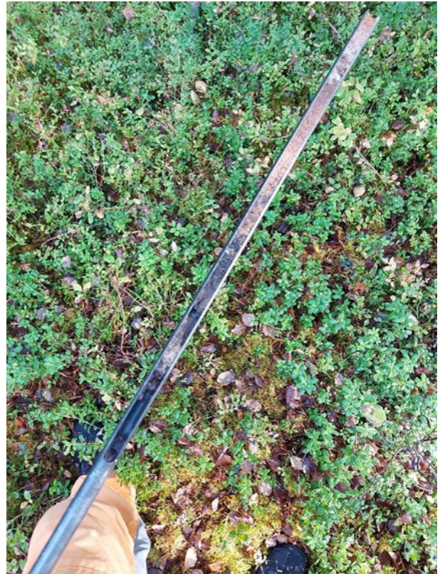
Kuva 21. Kairanäyte miilunpohjasta. Näytteessä erottuu vahva hiilikerros. Kuva: Risto Nurmi, Maanala Oy.
